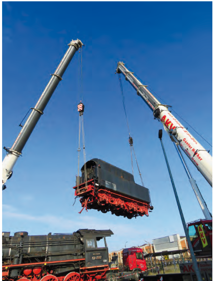
Der Schleptender wird auf den Tieflader umgesetzt
