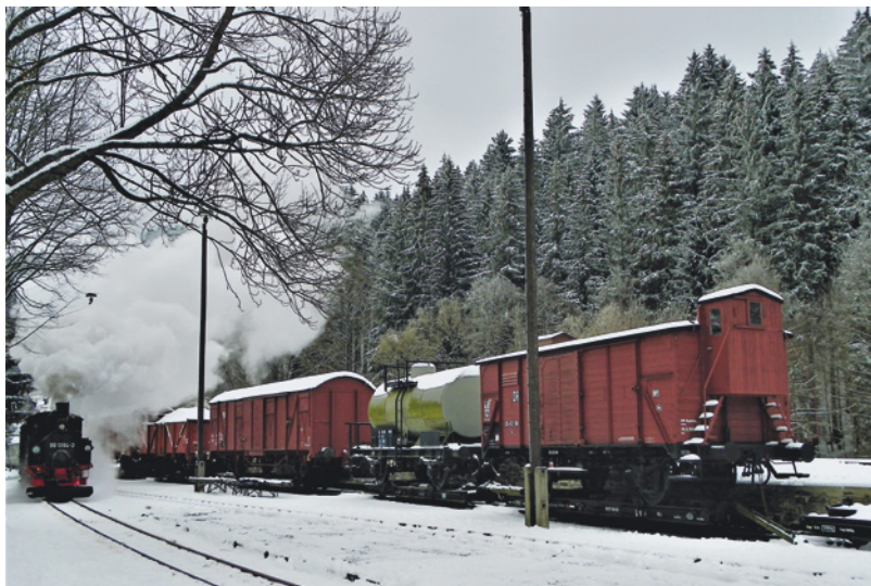
Einfahrt des Zuges aus Steinbach in Schmalzgrube, vorbei an mehreren regelspurigen Güterwagen auf Rollwagen an der alten Laderampe.
