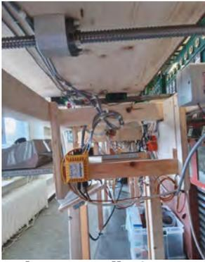
**Rahmengestell mit Führung und Spindel Unteransicht**
