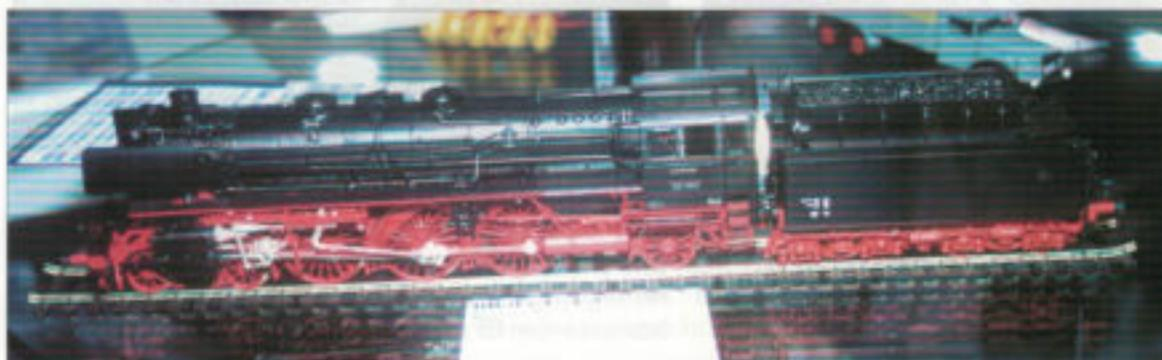
Die 03<sup>10</sup> von **Weinert** mit 2 Spitzenleuchten und vorn oben querliegendem Mischvorwärmer reizt zum Fahrbetrieb; ein prächtiges Modell.
