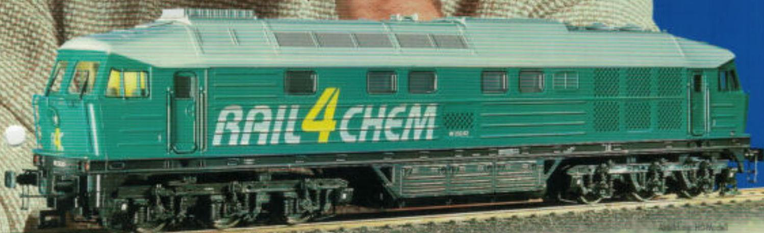
Für Zementzüge zwischen Deuna und Deutschenbora setzt die „Rail4Chem Eisenbahnverkehrsgesellschaft mbH“ zwei dieselelektrische Lokomotiven der früheren Baureihe 232 ein. Die Maschinen wurden im Jahr 2000 bei ADtranz technisch überholt und remotorisiert.
