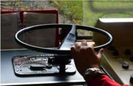
*Fahrstufenschalter des Triebwagens der Flachstrecke*
