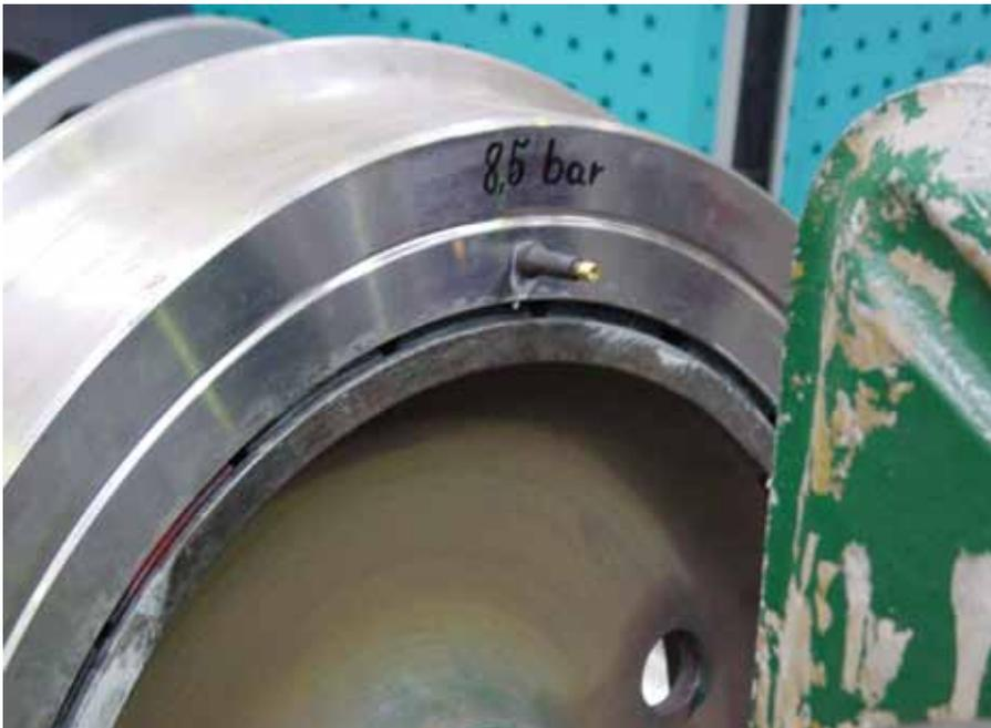
Die neue Luftfederung für Radreifen. Der obere Ring ist die Verschleißfläche des Radreifens
