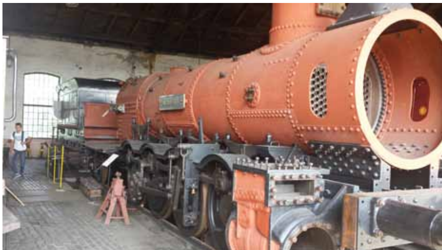
Der neue Kessel für die Lok aus 1866
