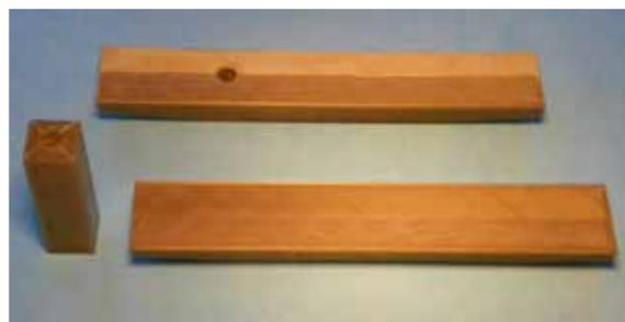
**Pfeiler und Querträger mit Bohrung für die Kabeldurchführung. Beim oberen Querträger ist die Schräge bereits angearbeitet, beim unteren erfolgte erst die Materialabtragung**
