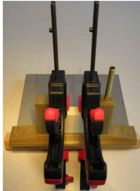
**Die kurzen Segmente und die Querträger werden unter Druck verklebt**
