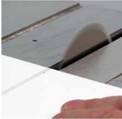
Dickere Kunststoff-Platten werden auf einem Minikreissägetisch von Proxxon zugeschnitten
