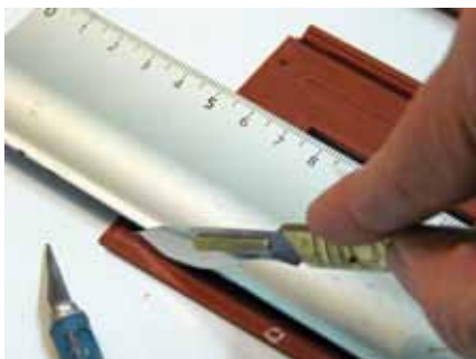
Dünne Kunststoff-Platten lassen sich mit einem scharfen Cuttermesser und einem Stahllineal schneiden
