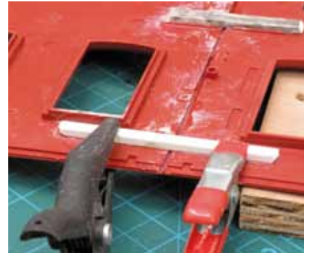
Wandteile werden zusammengefügt und mit Sekundenkleber geklebt. Manche Ecken bekommen noch eine Verstärkung aus Plastikprofil (aus der Restekiste) oder aus Holz
