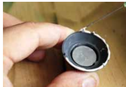
Auftragen der Spachtelmasse mit einer gewöhnlichen Spritze
