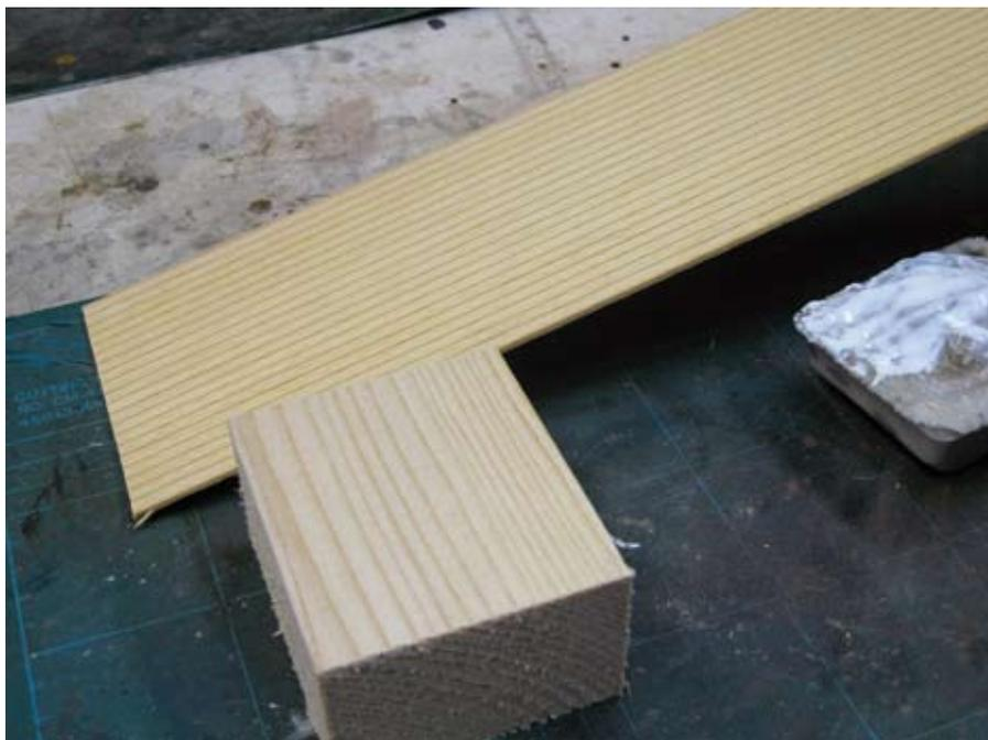
*Ein Holzklötzchen wird passend zum vorgesehenen Waggon zurecht gesägt. Das Triplex wird mit dem kleinen Kreissägetisch von Proxxon zugeschnitten. Der Holzklötz wird als Schablone zum Anzeichnen auf dem Triplex benutzt.*
