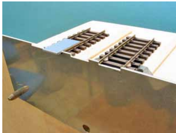
Gleis-Positionier-Schablone H0 in Anwendung, zingleisig
