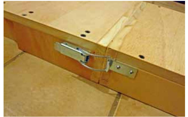
MOBAdul-Rapid-(Schnell) Verbindung von Modulen und Segmenten aufliegend
