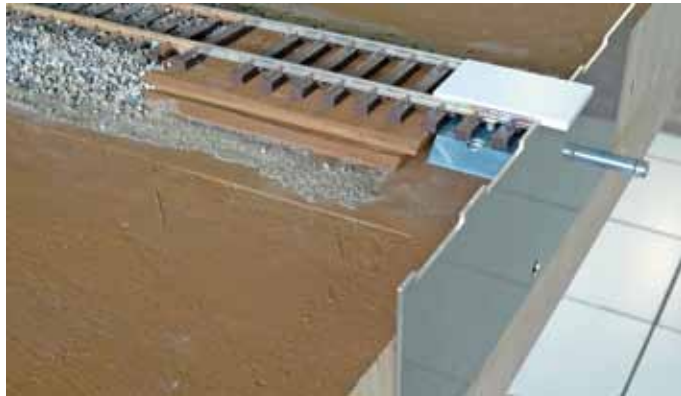
Gleis-Positionier-Schablone Spur 0 in Anwendung, eingleisig
