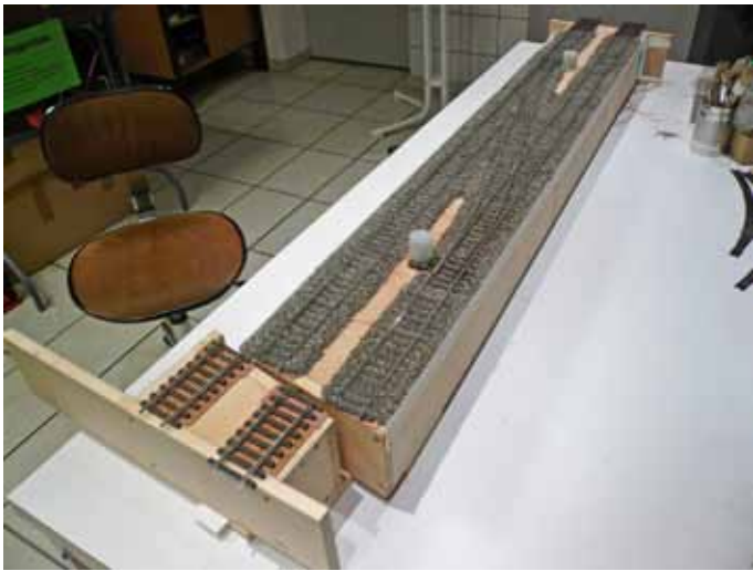
Türdurchgang mit beweglichem Brückenteil, Präzision durch Passbuchsen.
