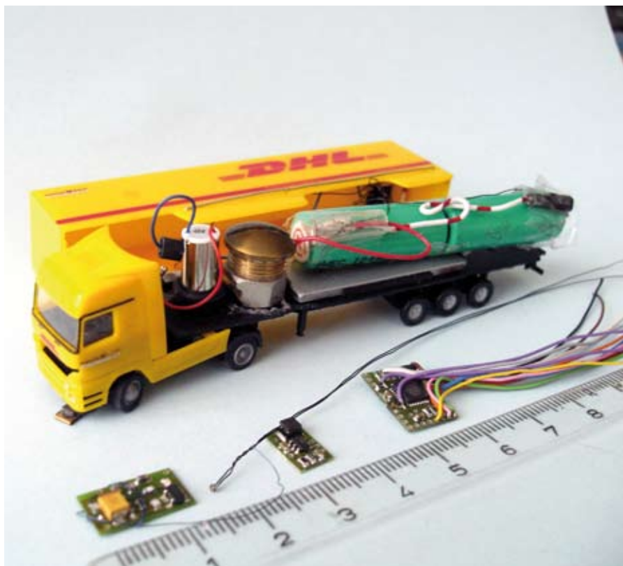
LKW offen, vor dem Einbau des Decoders und Spannungswandlers; Messschraube zur Erhöhung der Achslast
