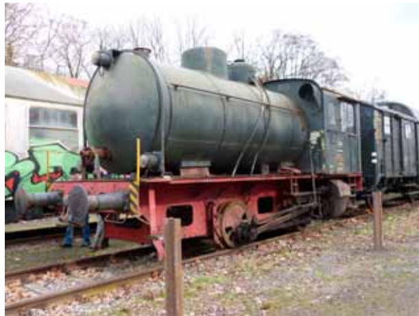
Henschel Dampfspeicherlokomotive ex im Papierwerk Felix Schoeller in Osnabrück- Lüstringen
