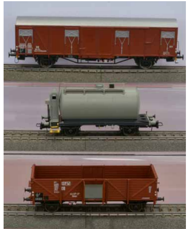
Gedeckter Güterwagen der Regelbauart „GbrS“, Kesselwagen „Uerdingen“ 24 m 3 und offener Güterwagen der Bauart „Ommr“
