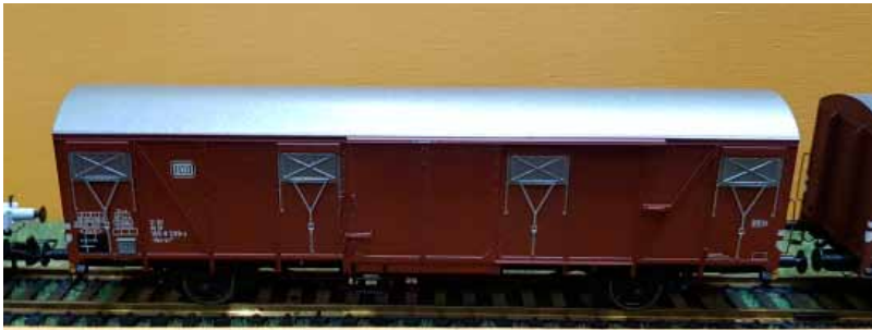
Gedeckter Güterwagen mit Einzelradsätzen der Bauart „Obs“
