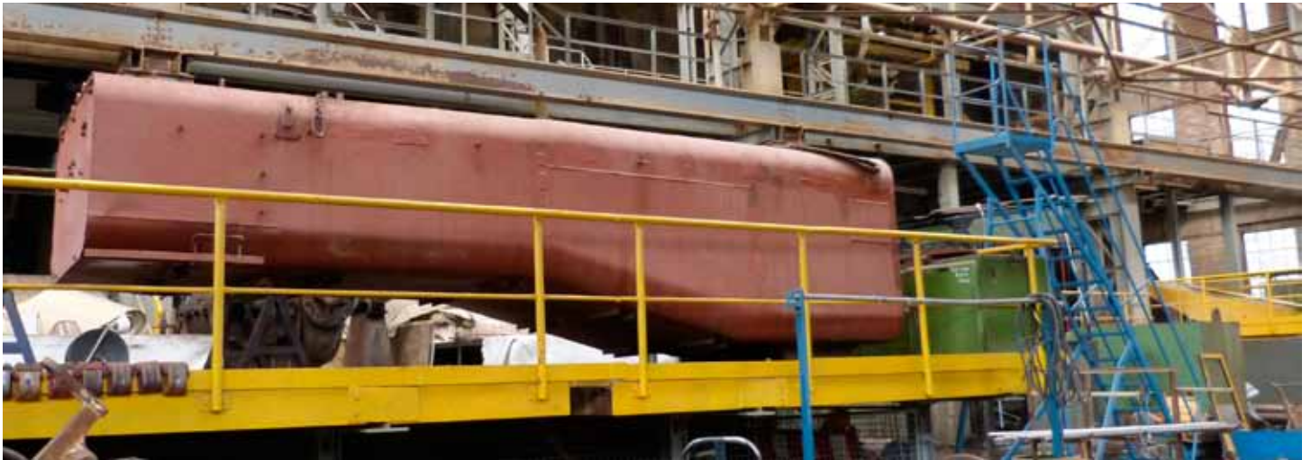
Tendereinsatz (Öltank) für die 41 052
