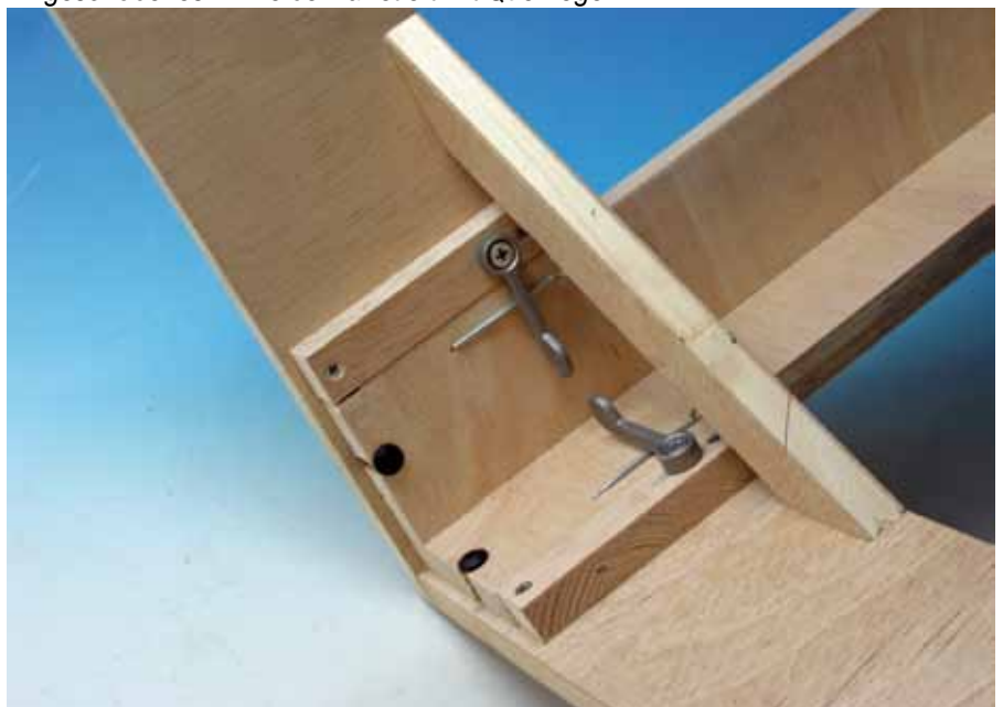
Eingeschobenes Winkelbein arretiert mit Querriegel
