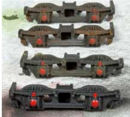
*Die Drehgestellblenden in den einzelnen Arbeitsschritten. Grundiert, Pulverfarbe „Dark Earth“, Pulverfarbe „Track Rust“, Etwas „Light Rust“ Wash auf die Federpakete. Zwischen jedem Arbeitsschritt wird das Pulver mit „Ultra Matte Varnish“ fixiert*
