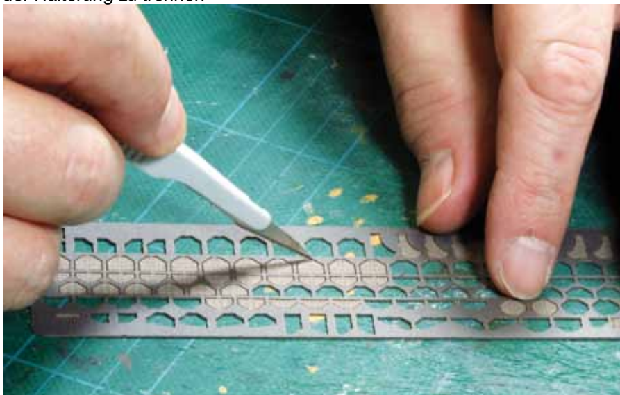
H0: Nur ein Skalpell ist dünn genug, um die 133 Knotenbleche vorsichtig aus der Halterung zu trennen
