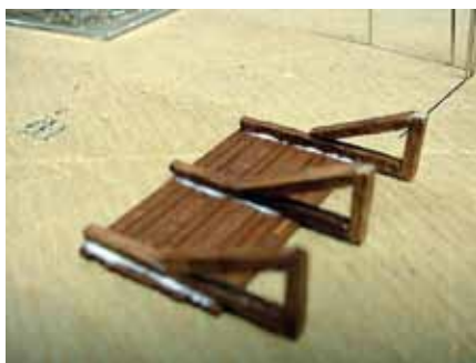
Die Pfosten werden einfach von hinten auf die Bretter geklebt
