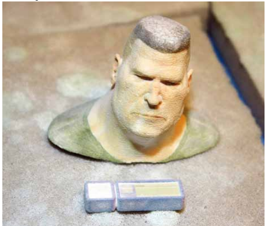
Ein Kopf und eine Bahnsteigsanzeige (NL) im Rohzustand direkt aus dem mehrfarbigen Kunststoffdrucker
