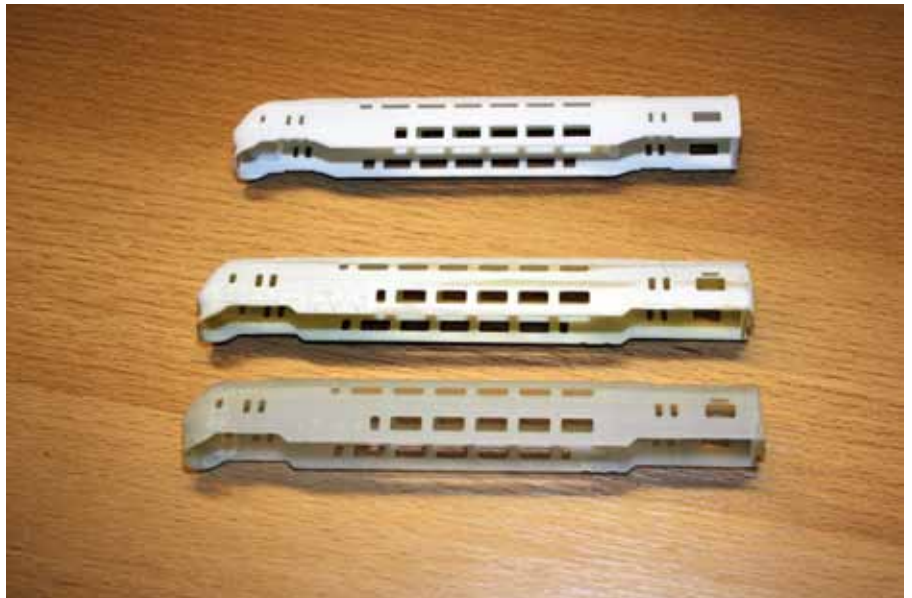
Unten: unbehandelt, Mitte: grundiert, Oben: geschliffen nach mehrfachen Grundieren
