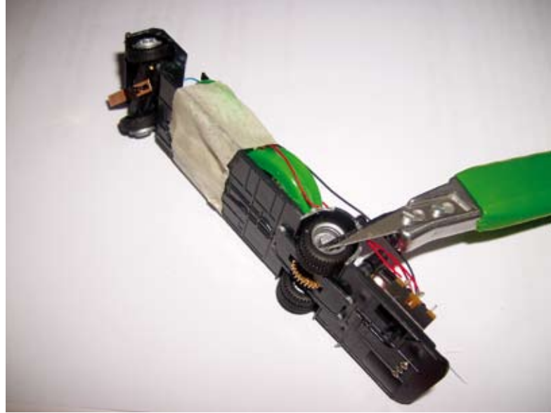
Abtrennen der vorstehenden Radkastenstreifen
