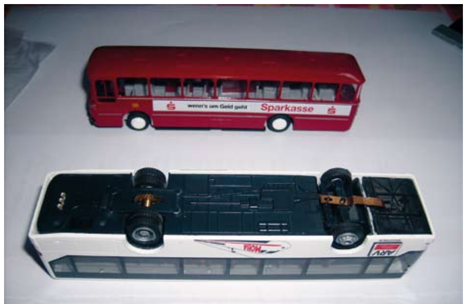
Gut zu erkennen ist die Trennlinie im neuen Fahrgestell des MOBA-Busses
