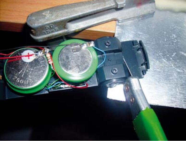
Beim Abtrennen des vorderen Fahrgestellteils liegt die Vorderachse mit dem Schleifer geschützt unter der Alu-Platte
