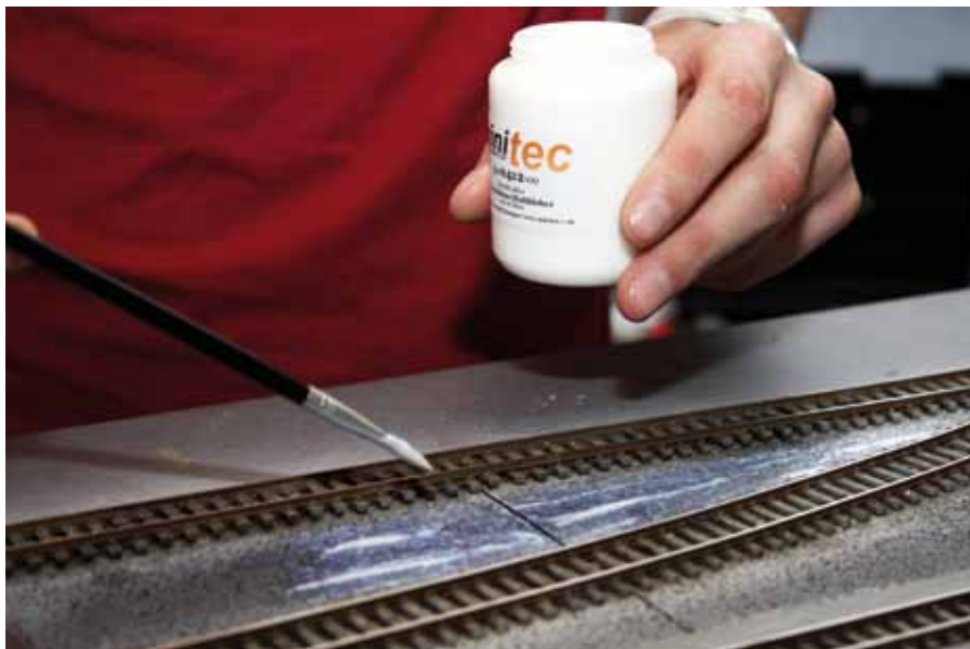
Im nächsten Schritt wird Matt-Kleber aufgetragen
