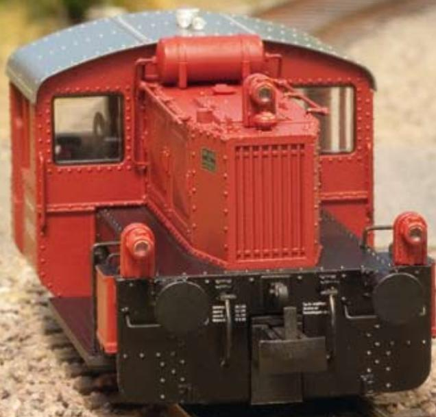
Und zwar ein Hämmerchen! Denn unsere **HO Köf** hat nicht nur **Fahrwerk und Gehäuse aus Metall**, nein, sie ist **auf beiden Achsen angetrieben** und die hintere Achse ist zur besseren Stromabnahme pendelgelagert.
