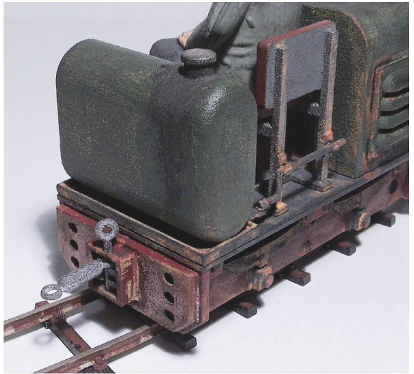
Hier die grüne „Großdiesellok“. Der Maschine sieht man den harten Arbeitsalltag an. Deutlich ist die Kuppelstange zum Anhängen der Loren erkennbar.
