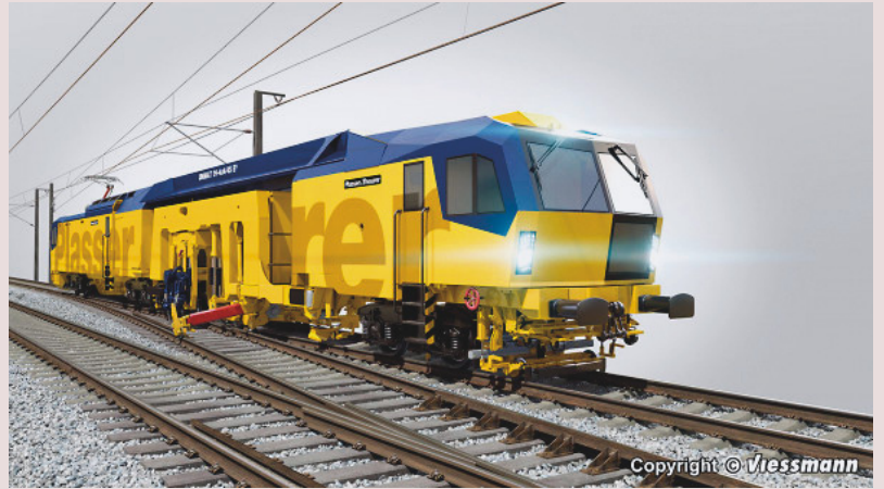
Gleisstopfmaschine; Foto: Plasser & Theurer
