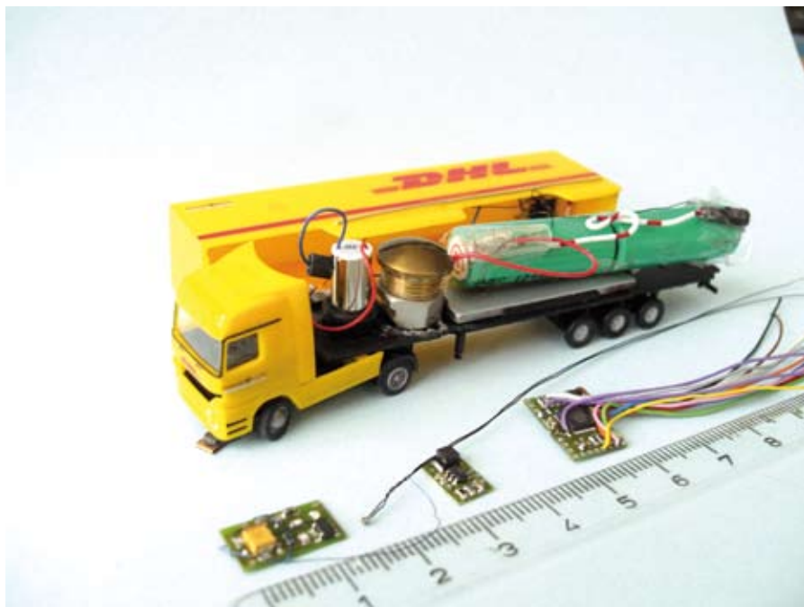
So siehts eingebaut aus
