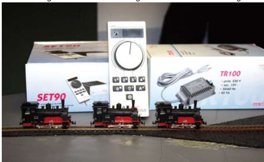
LH90 Handregler und drei Loks mit eingebauten Decodern werden getestet
